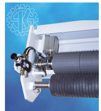
Nem og enkel betjening af modtryksvalsen sikrer effektiv trådning af plastfolien.
